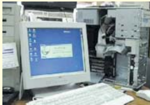
パソコンのフタをとっばらって、ハードディスクを差し替える。
